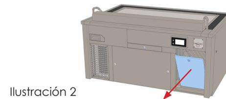
**Nota:** Con la puerta de la grasa desatornillada, incline la puerta hacia afuera y levante hacia arriba para levantar la puerta del canal metálico inferior. Cuando la puerta esté hacia adelante del canal metálico, incline la puerta hacia afuera para quitarla.
